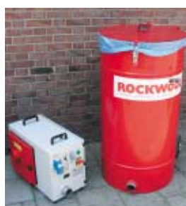
Absauggerät mit Auffangbehälter
